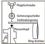
Zunächst den Kartuschen-Führungsring am Pressenkopf montieren. Dieser schützt die Kartusche und sorgt für einen sicheren Halt.
